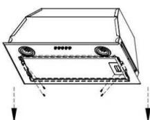
Надежно закрепите корпус вытяжки к шкафчику 12 винтами.
